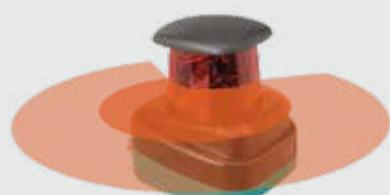
SRC 核心控制器实时获取导航激光雷达的数据，数据采集频率高达 30Hz，并通过实时的算法对采集的数据进行计算，如果有物体进入机器人的减速或停止范围内，机器人将减速或立即停止。
