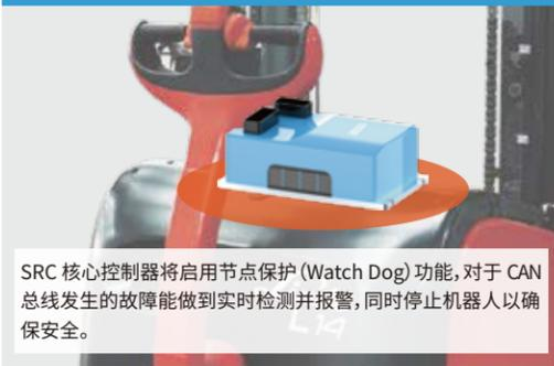
SRC 核心控制器将启用节点保护 (Watch Dog) 功能，对于 CAN 总线发生的故障能做到实时检测并报警，同时停止机器人以确保安全。
