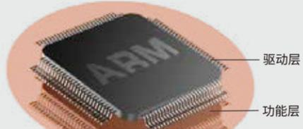
SRC 核心控制器采用双层架构，分别为驱动层与功能层，驱动层使用稳定的嵌入式 ARM 芯片，功能层为智能导航及避障算法，若功能层发生不可预计的错误，驱动层可实时检测到并立即停止机器人，以防止机器人失控。
