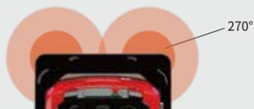
避障激光雷达的 DO 接入 SRC 核心控制器的 DI，避障激光雷达检测到物体进入机器人的减速或停止范围内时将输出电平信号，SRC 核心控制器接收到信号后立即使机器人减速或停止。SRC 核心控制器对 IO 信号的检测频率高达 1000Hz。避障激光雷达可用于覆盖导航激光雷达无法检测到的盲区。
