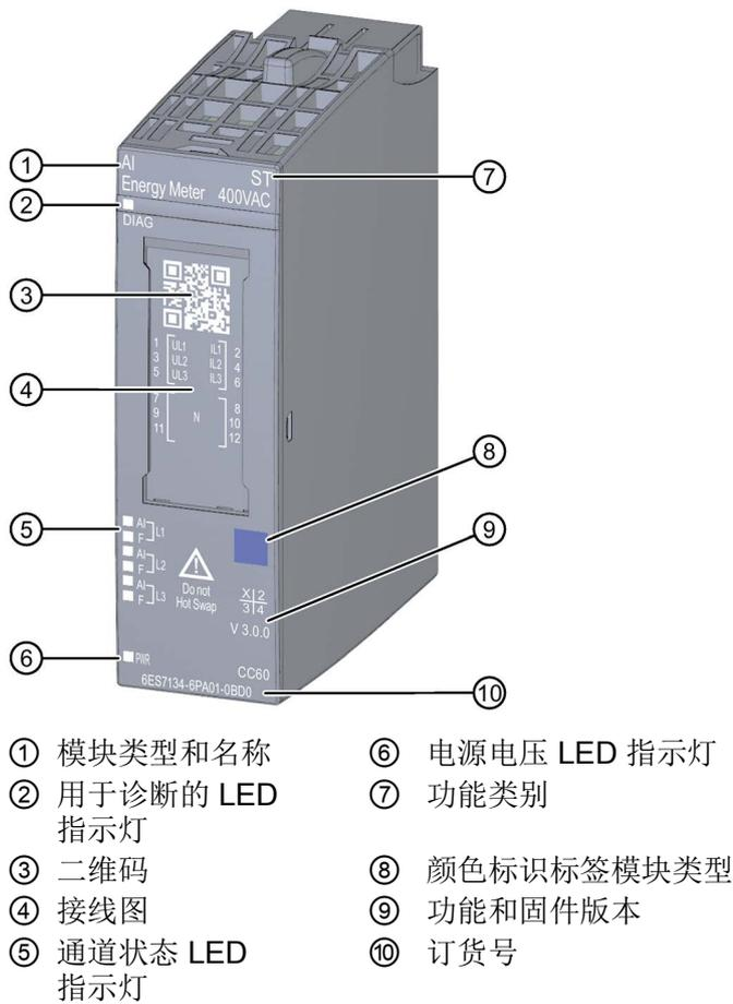
图 2-2 AI Energy Meter 400VAC ST 模块的视图
