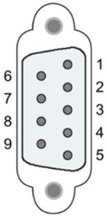
Tabelle 3- 3 Kontaktbelegung der Sub-D-Buchse
