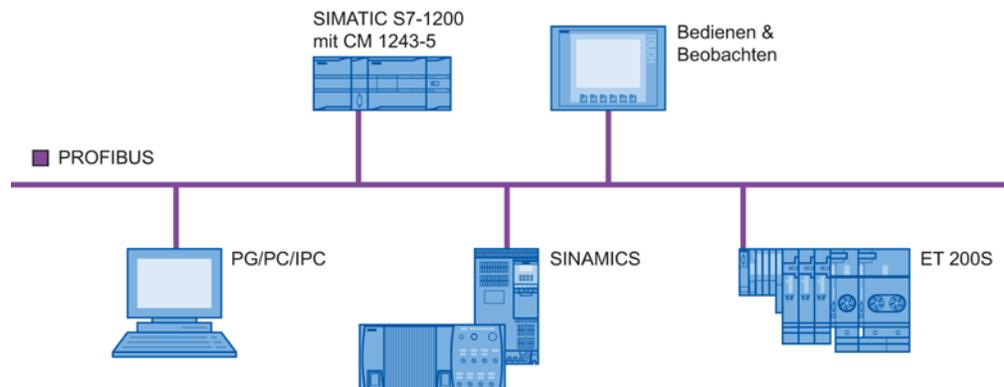
Bild 1-2 Konfigurationsbeispiel mit CM 1243-5 als PROFIBUS-Master
