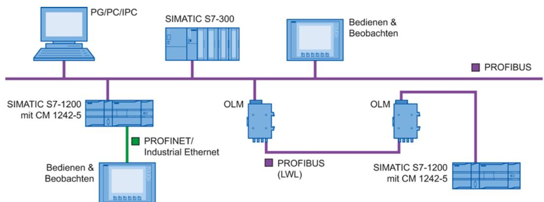
Bild 1-1 Konfigurationsbeispiel mit CM 1242-5 als PROFIBUS-Slave
