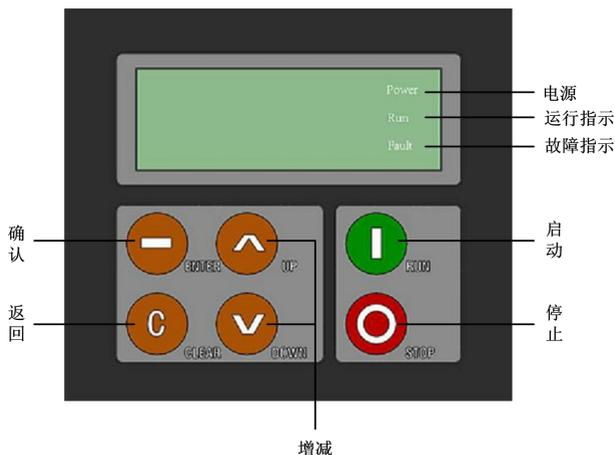
**!** 启动过程、全压、软停过程中 LED 面板上都显示平均电流。面板的上面有 3 个 LED 指示灯。LED1 标识符为 POWER，主板电压正常时常亮；LED2 标识符为 RUN，在启动过程中是闪烁的，启动完成后常亮；LED3 标识符为 FAULT，当故障时点亮。
