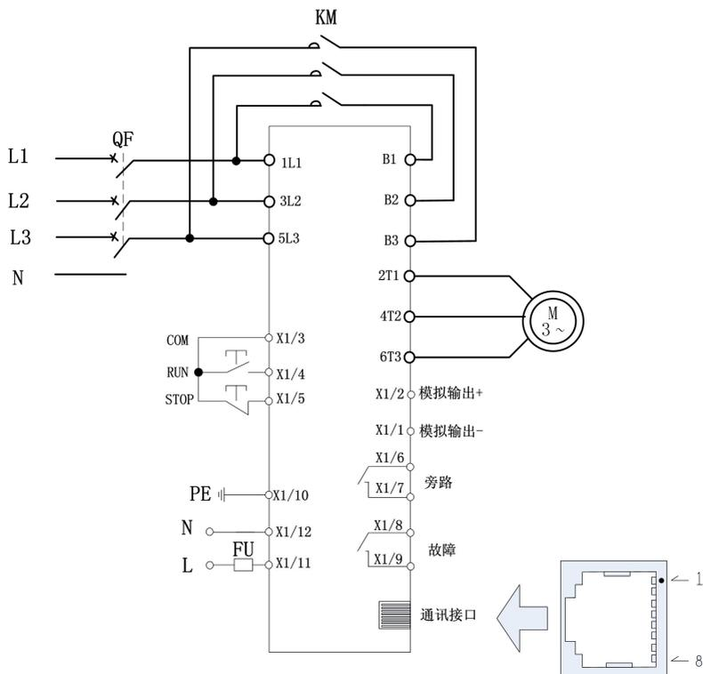
注：通讯接口是功能选配口，采用光纤水晶头的联结端子，如图所示从上到下依次是 1 脚到 8 脚。具体端子定义请参考端子定义。
