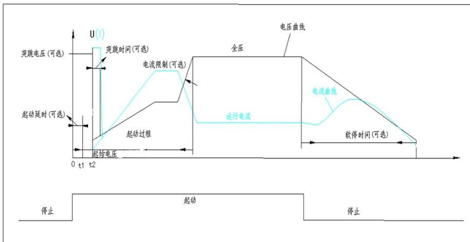
软起\软停电压(电流)特性曲线
