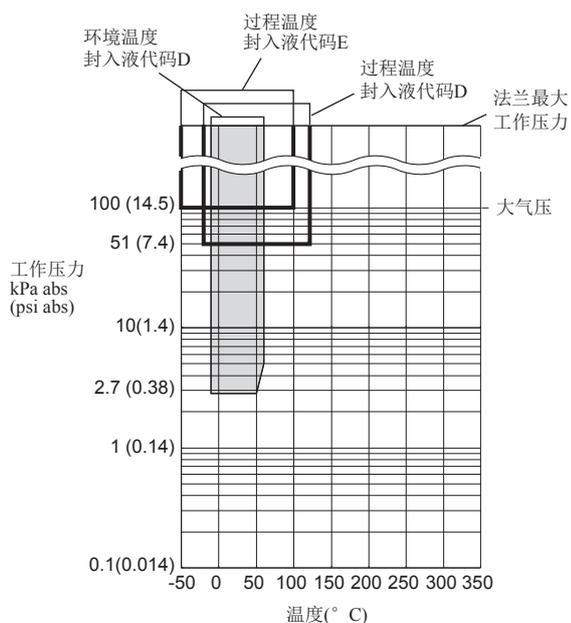
图1-2. 工作压力和过程温度
