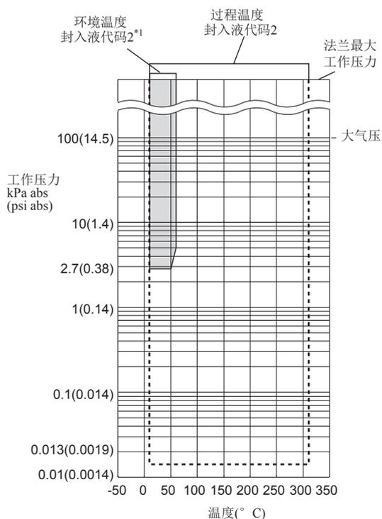
图1-4. 工作压力和过程温度
