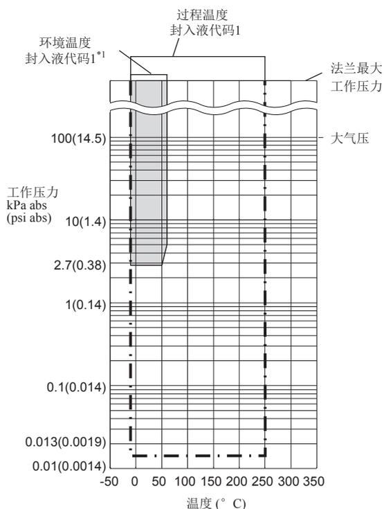
图1-3. 工作压力和过程温度
