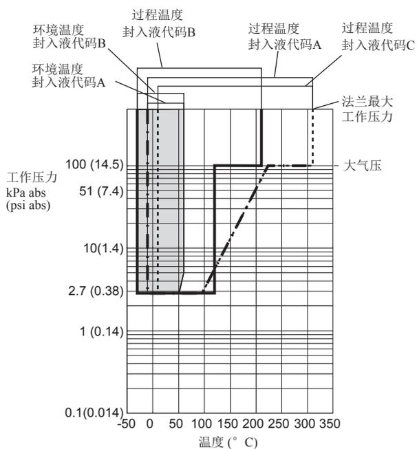
图1-1. 工作压力和过程温度
