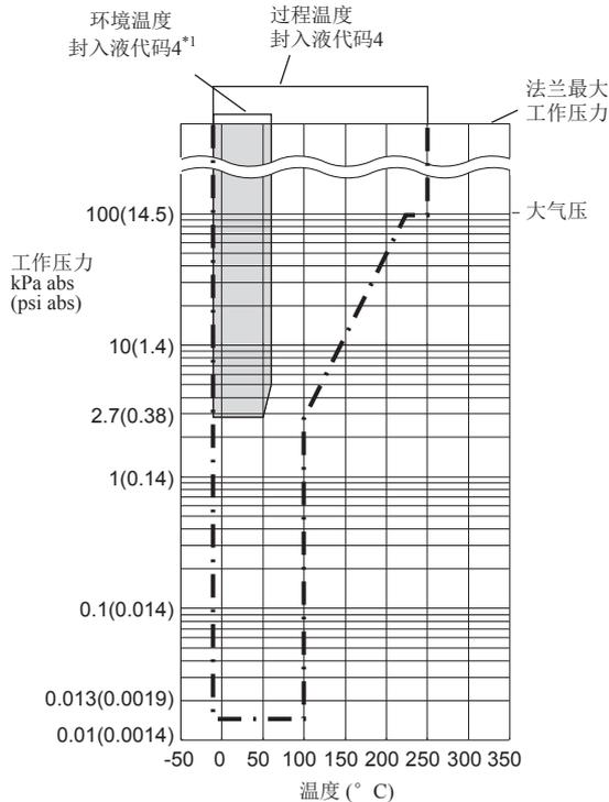
图 1-5. 工作压力和过程温度
