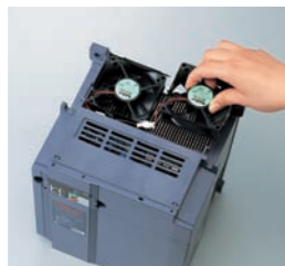
拆下电源连接器,交换冷却风扇。
